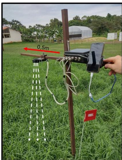
Figura 1. Estrutura metálica utilizada para acoplamento dos sensores e esquematização do movimento realizado para coleta dos dados pelos sensores em uma faixa de 0,5 m sobre o dossel forrageiro. **Metallic structure used to move the sensors and scheme of collection carried out in a range of 0.5 m over the forage canopy.**
