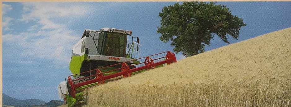
Máquinas da empresa alemã Claas sempre inovam no quesito tecnologia. A colhedora da foto, por exemplo, possui sistema de nivelamento da cabine para atuação em terrenos com grandes inclinações
