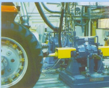
Ensaio de desempenho de tratores na TDP realizados no “Nebraska Tractor Test laboratory”, em Lincoln, Nebraska
