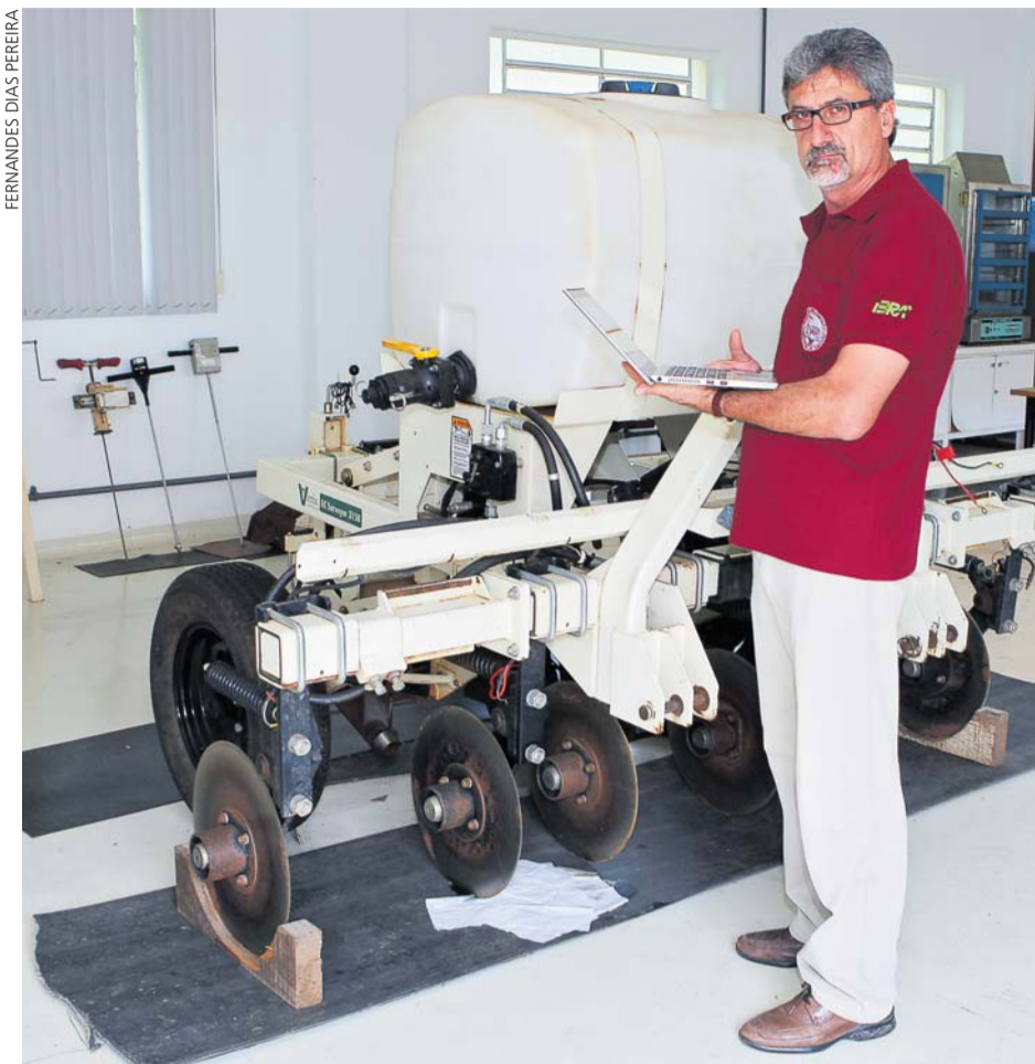
O engenheiro Molin e o equipamento que detecta umidade na terra por meio de circuito elétrico
