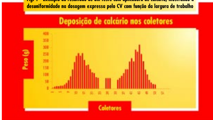
Fig. 2 - Exemplo do resultado de um teste com aplicadora de calcário, mostrando a desuniformidade na dosagem expressa pelo CV com função da largura de trabalho
